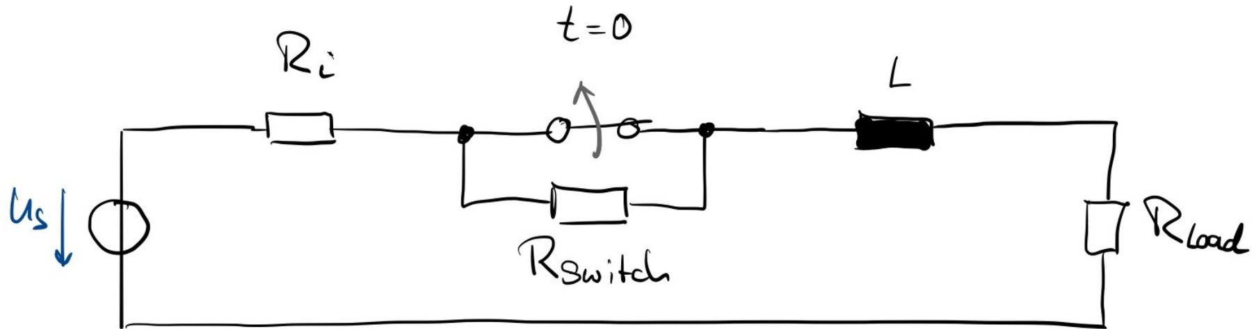
Gesucht: Spannung über dem Schalter im Verhältnis zur Quellspannung  $U_{\text{switch}}/U_s$  bei  $t = 0$
