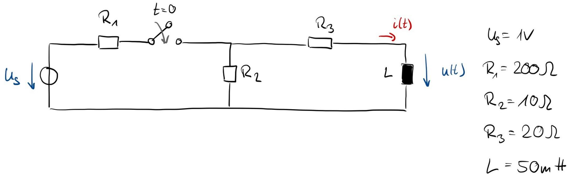
Vor Schließen des Schalters im Zeitpunkt  $t = 0$  fließt kein Strom durch die Induktivität.
