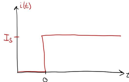
*Eine unendlich hohe Spannung ist technisch nicht möglich! Eine Begrenzung der Spannung kann durch einen zusätzlichen parallelen Widerstand erreicht werden.*
