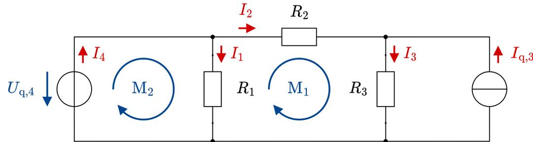
Beim Aufstellen der Maschenwiderstandsmatrix ist Spannungsquelle als *Kurzschluss* zu betrachten
