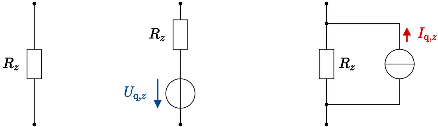
*Nun:* Berücksichtigung von Zweigen mit idealen Spannungs- oder Stromquellen prinzipiell möglich
