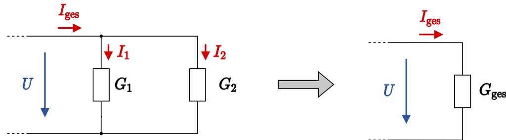
$$I_{\text{ges}} = I_1 + I_2 \quad \text{mit} \quad I_1 = G_1 \cdot U \quad \text{und} \quad I_2 = G_2 \cdot U$$
